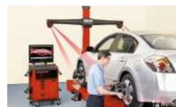
Конкурсанту необходимо провести диагностику рулевого управления, подвески автомобиля, определить неисправности, устранить неисправности, провести необходимые метрологические измерения, провести сборку, привести системы в рабочее состояние. Выполнить операцию «сход-развал». Результаты записать в лист учета.
