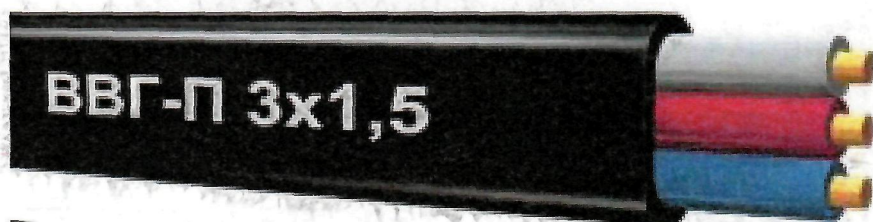
Рис. 8 Винил Виниловый, Гибкий, медный, Плоский провод с цельными жесткими жилами с двойной изоляцией из поливинилхлоридного пластика
