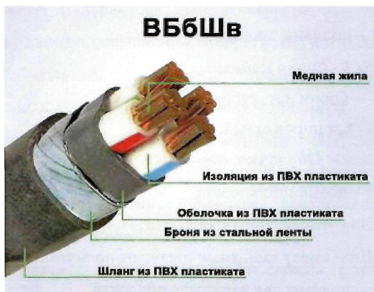
Рис.16 Виниловый, Броня, Броня, двухленточная, Шланг защитный
